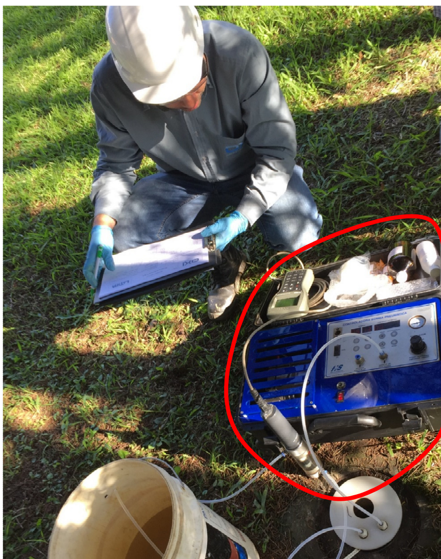
Figura 10. Detalhamentos do equipamento multiparâmetro e acessórios utilizados na amostragem de água subterrânea da STRATURA / UNIDADE DE CAMPO LARGO – PR, em dezembro de 2015.
