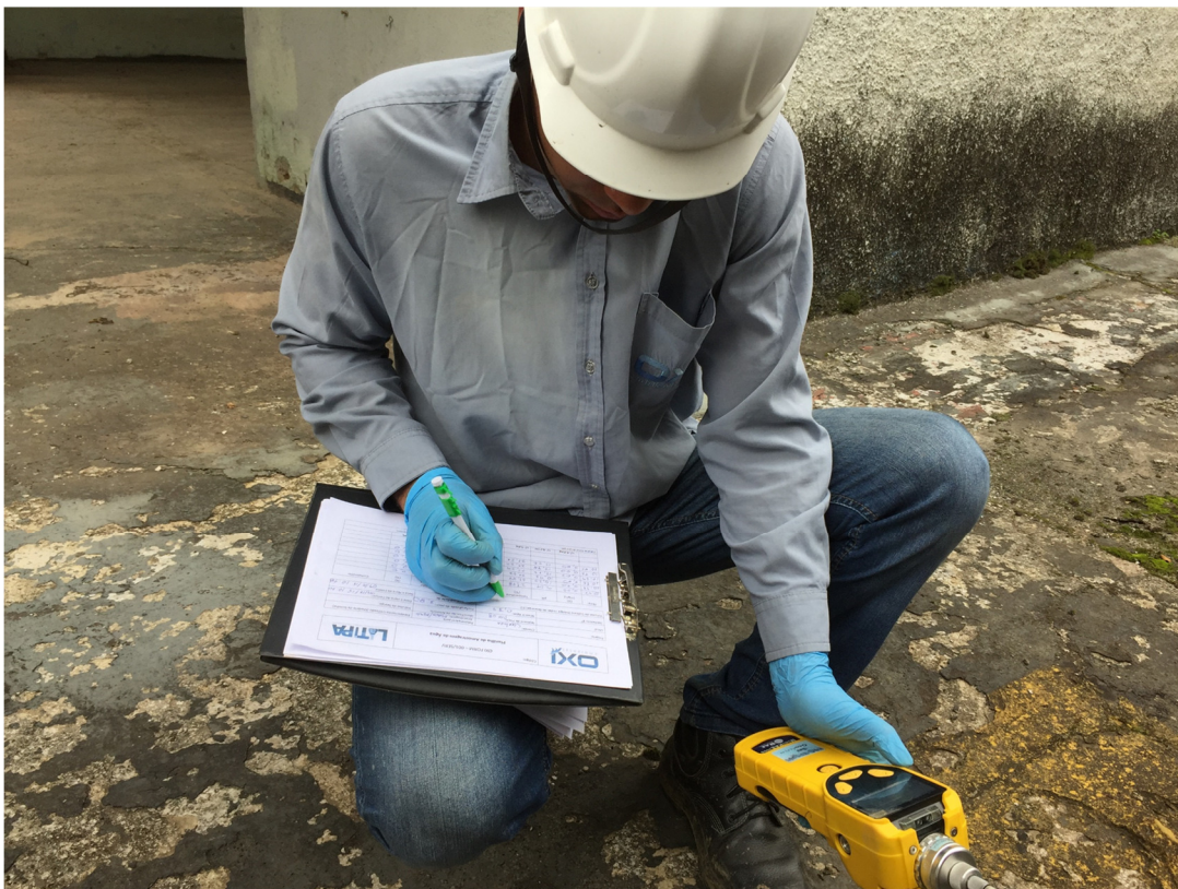
Figura 16. Medição de VOC na subsuperfície do solo na área da STRATURA – Campo Largo – PR.
